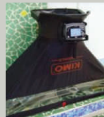
Ballomètre permettant de mesurer des débits pour de grandes bouches - AMOES
