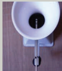
Anémomètre à fil chaud avec un cône pour la mesure des débits aux petites bouches - AMOES
